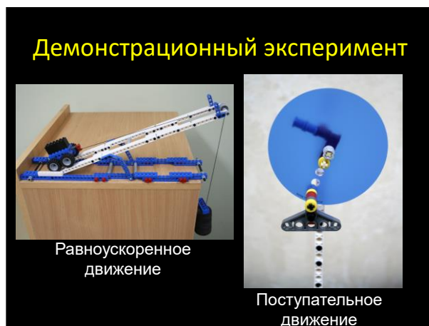
Рисунок 4 – Использование конструктора LEGO для демонстрации равноускоренного движения
