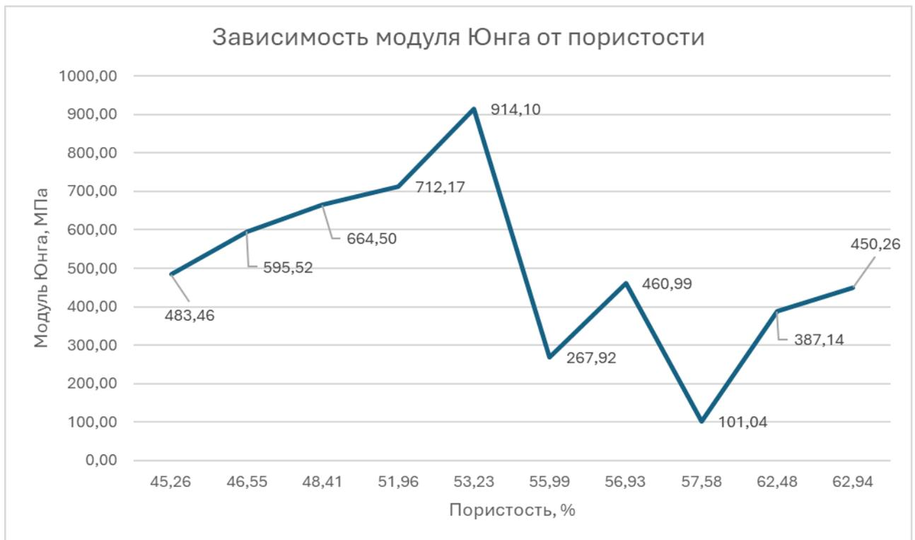
Рисунок 4 – График зависимости модуля Юнга от пористости у продольных образцов
