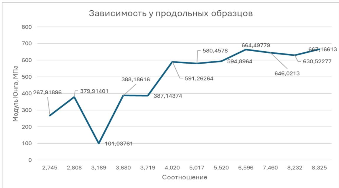
Рисунок 2 – Зависимость модуля Юнга от соотношения у продольных образцов (ось Z)
