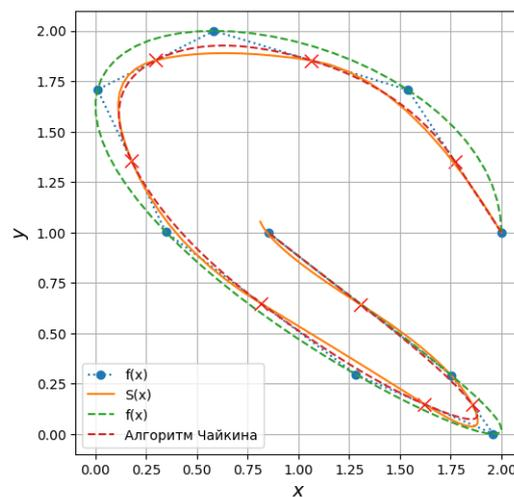
Рисунок 6 — Интерполяция функции, заданной таблично сплайном  $S_*(x)$ , полученного сдвигами функции  $\varphi(x) = \psi(\frac{n}{4}x)$  при  $M_0^x = 7.5$  и  $M_0^y = -12.5$
