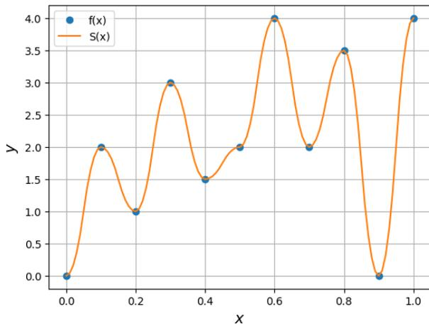
Рисунок 1 — Интерполяция функции, заданной таблично, сплайном  $S(x)$ , полученным сдвигами функции  $\varphi(x) = \psi(\frac{n}{2}x)$
