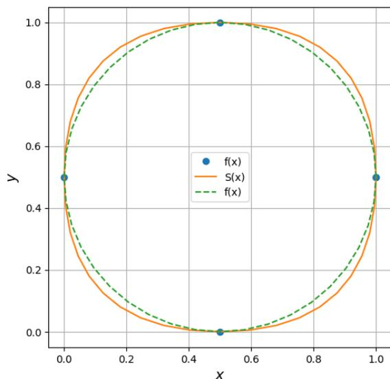
Рисунок 3 — Интерполяция окружности  $f(x)$  сплайном  $S_*(x)$  при  $M_0^x = 0$  и  $M_0^y = 4$
