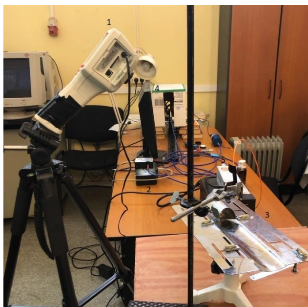
Рисунок 2 – Схема экспериментальной установки. 1 – тепловизор, 2 – спектрометр, 3 – столик для крепления крысы, 4 – персональный компьютер, 5 – лазер.
