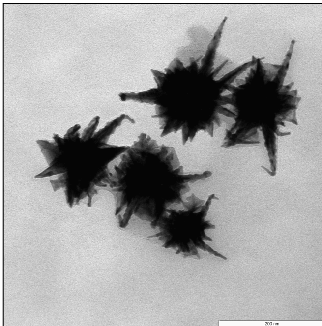
Рисунок 3 – ПЭМ-изображение образца золотых нанозвезд, масштабный отрезок – 200 нм.
