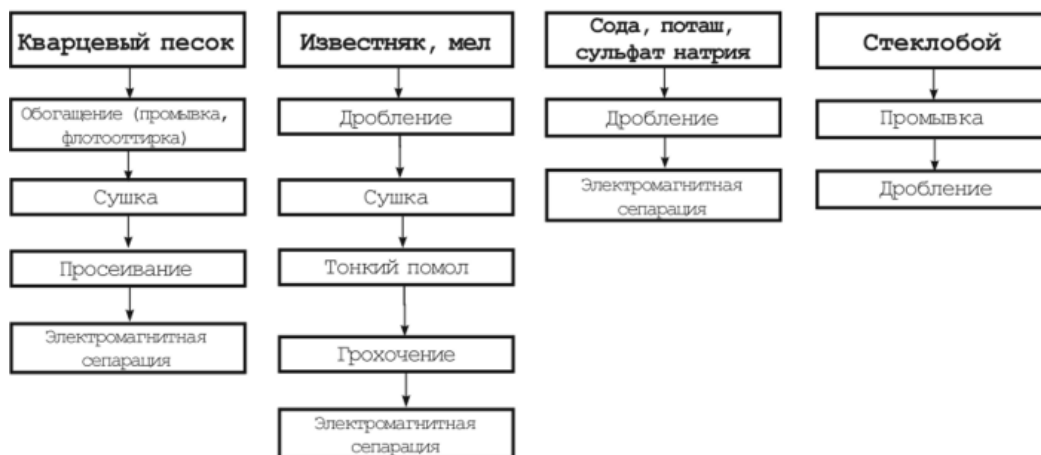
Рисунок 1– Схема предварительной обработки сырьевых компонентов для производства стекла [4]
