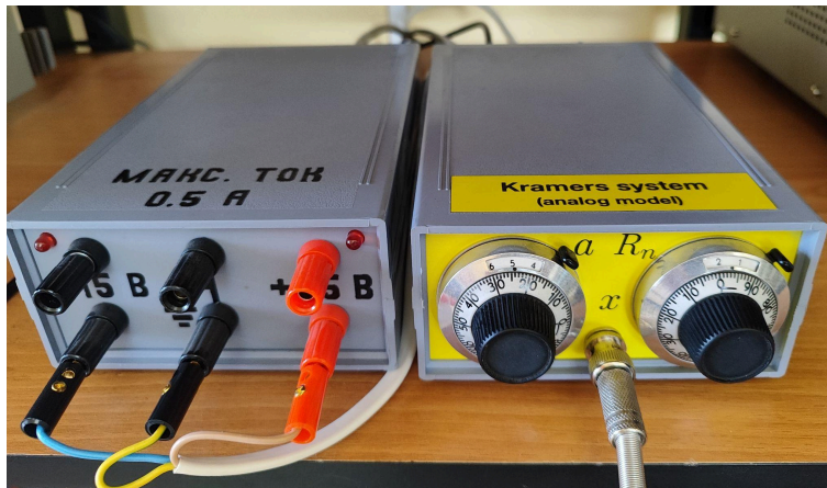
Рисунок 2. Физическая модель осциллятора Крамерса
