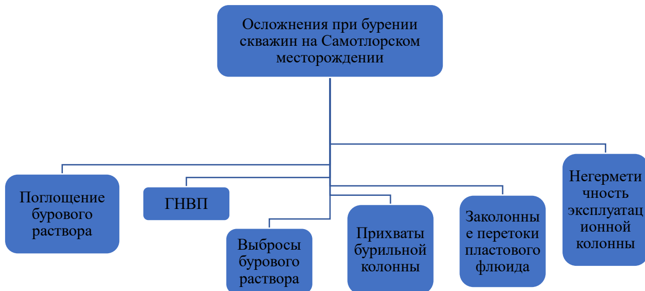
Рисунок 2 – Осложнения при бурении скважин на Самотлорском месторождении
