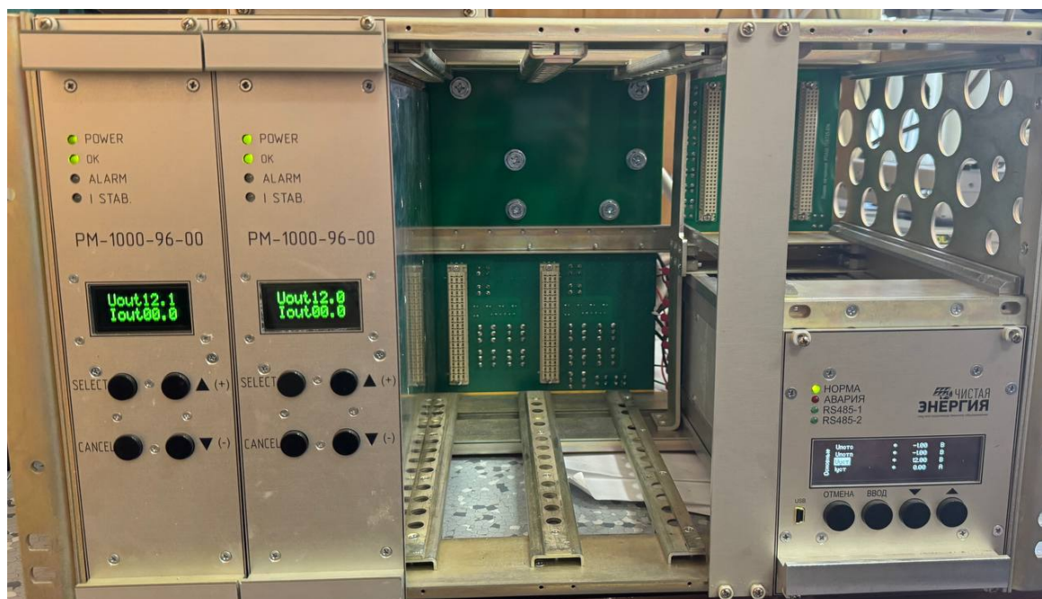
Рисунок 4 – Установка из источников питания и устройства для опроса
