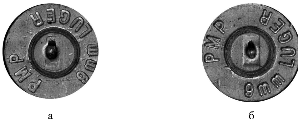
Рисунок 1 – Дно гильз, стреляных в: а – пистолете Glock 17; б – пистолете Glock 19
