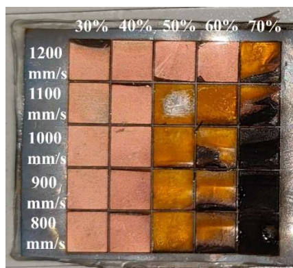
Рисунок 6.1. Матрица режимов на многослойной полиимидной подложке Cr-Cu-Cr с параметрами: 100 kHz, 14 ns, 100 lines/mm, энергия в лазерном импульсе при 100% мощности 60 \mu J, 2 повторения.
