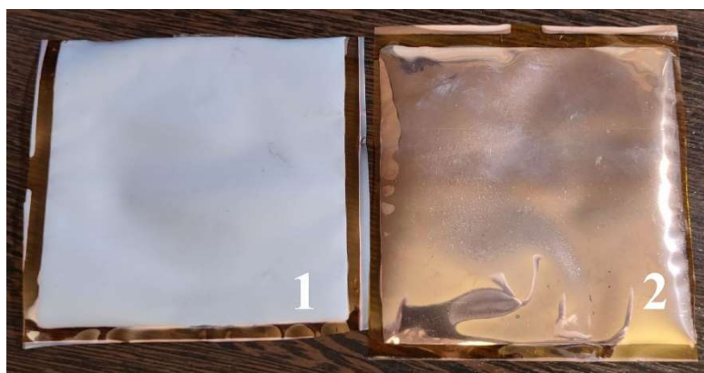
Рисунок 2.1. Пример гибкой диэлектрической подложки с нанесенными в процессе магнетронного распыления слоями хром-медь-хром (1) и гибкая подложка с нанесенными в процессе магнетронного распыления слоями титан-медь (2).
