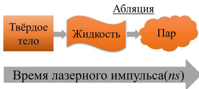
Рисунок 1.2 Блок-схема состояния металла на протяжении одного наносекундного импульса.
