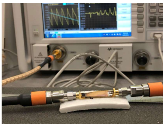
Рисунок 5.1. Экспериментальное исследование изготовленной линии передачи на векторном анализаторе цепей СВЧ диапазона.
