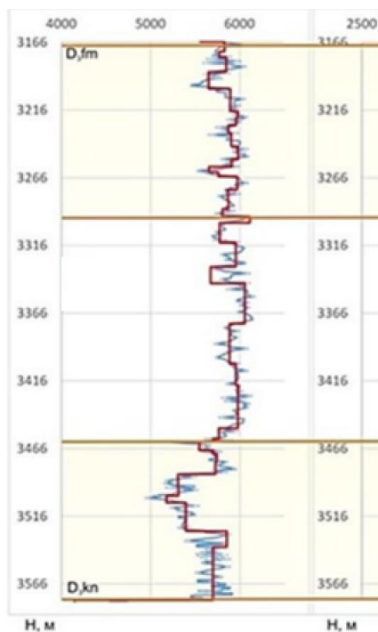
Рисунок 2 - СГМ2- тонкослоистая скоростная модель V_p составленная по данным ГИС скважины 36 – Алдаркинская. Не содержит коллекторов
