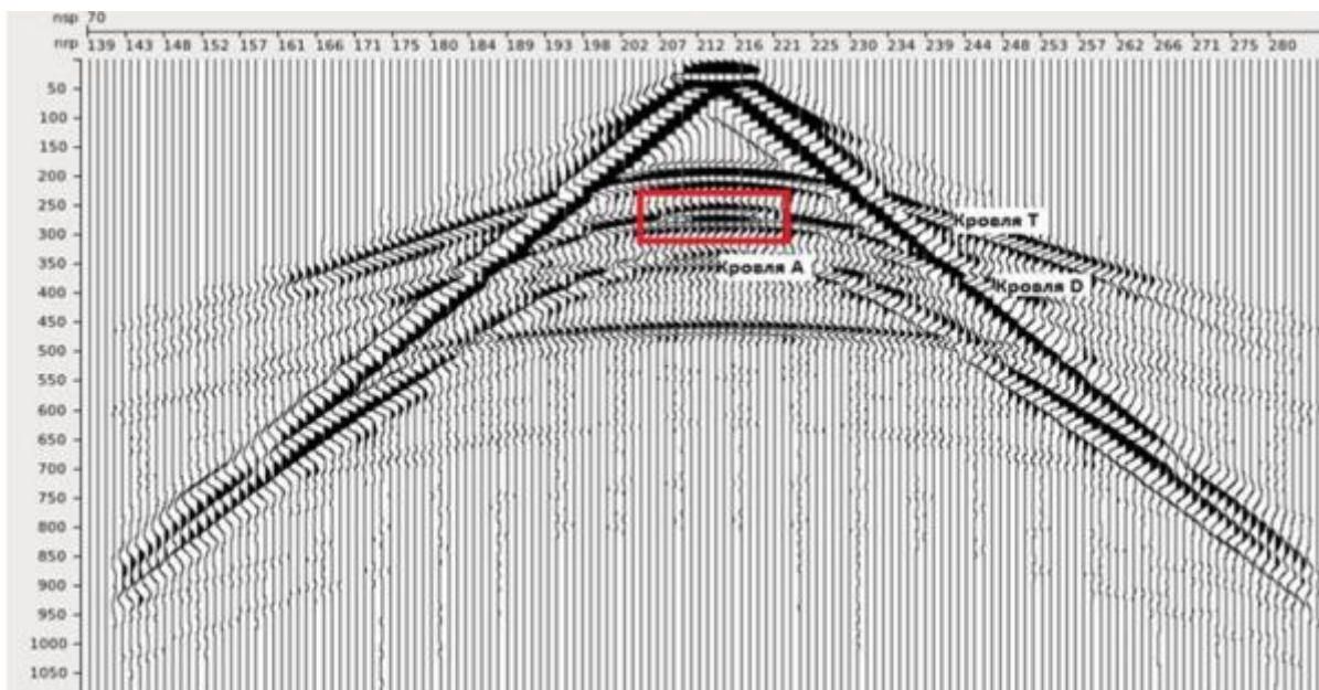
Рисунок 5 - Синтетическая сейсмограмма ОПВ для СГМ3 (Z-компонента полного волнового поля)
