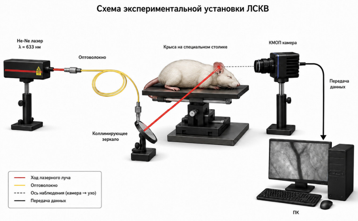
Рисунок 1. Схема экспериментальной установки: детектор (КМОП-камерой (Thorlabs CS235MU серии Kiralux, число пикселей в матрице 1920x1200 пикселей (2.3 Мп), размер пикселя 5.86x5.86 мкм; 12 бит/пиксель); тубус микроскопа с объективом ЛОМО 3.7x; He-Ne лазер ГН-5П, длина волны — 633 нм; расширитель
