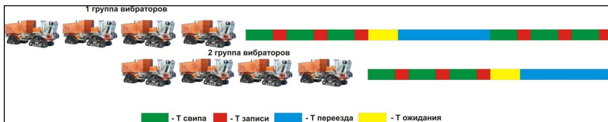
Рисунок 1 – Схема отработки методом «Flip-Flor»
