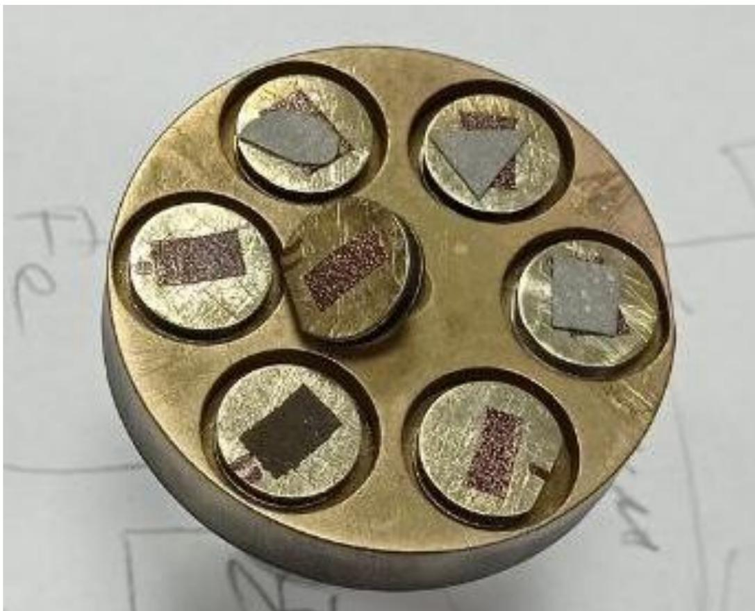
Рисунок 7 – Образцы с золотым напылением
