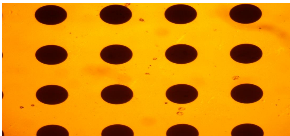
Рисунок 1 – Снимок с микроскопа метаповерхности в виде структуры ЖИГ ( 15 \text{ мм} \times 3 \text{ мм} \times 10 \text{ мкм} ) с решёткой из пермалловых дисков диаметром 160 мкм и толщиной 200 нм. Расстояние между дисками равно их диаметру.
