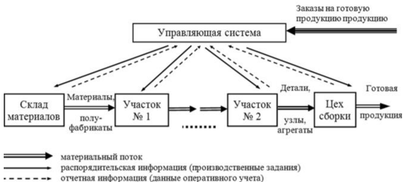
Рисунок 1 – Данные для задачи 1.5. Границы логистической системы (на основе обращения цикла средств производства)
