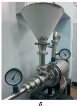
Рис. 3. Схема (а) и общий вид (б) устройства для смешивания сыпучих компонентов с жидкостью: 1 – загрузочная камера; 2 – рабочая камера; 3 – нагнетательный патрубок; 4 – питающий патрубок; 5 – рабочее колесо; 6 – полая втулка; 7 – подшипник; 8 – уплотнения; 9 – заслонка; 10 – лопатки
