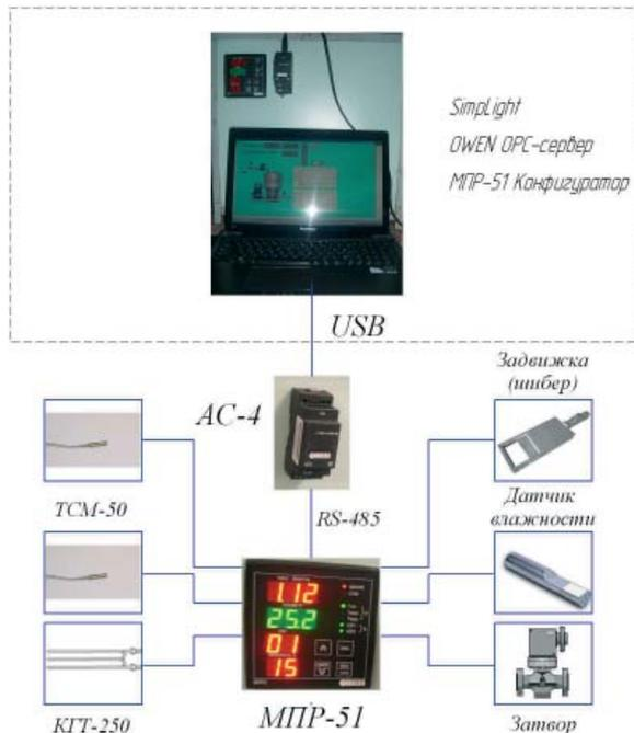
Рис. 2. Схема системы управления сушкой зерна на базе измерителя-регулятора MPP-51-Щ4
