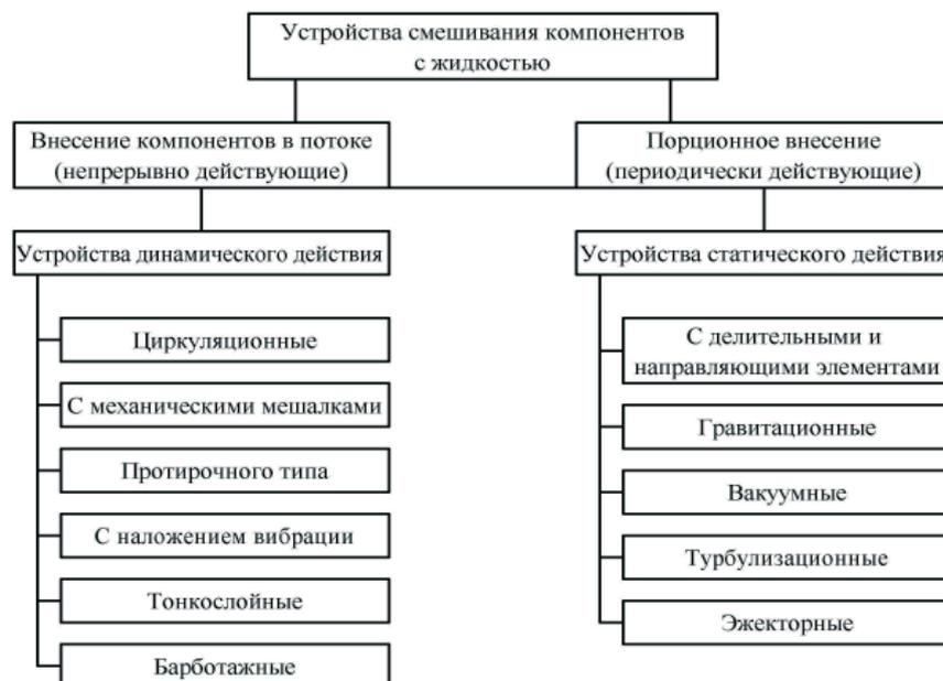
Рис. 2. Классификация устройств смешивания компонентов с жидкостью [2]
