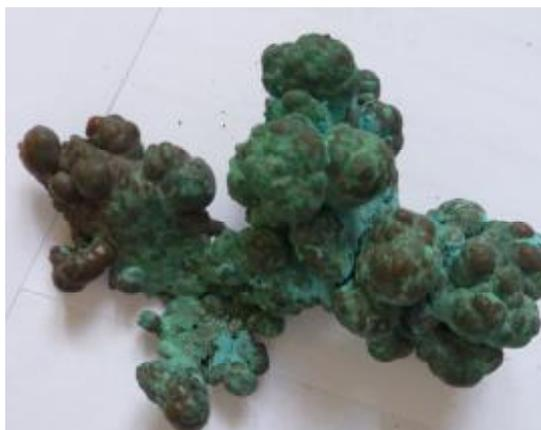
Рис. 4. Образование патины на поверхности металлической меди
