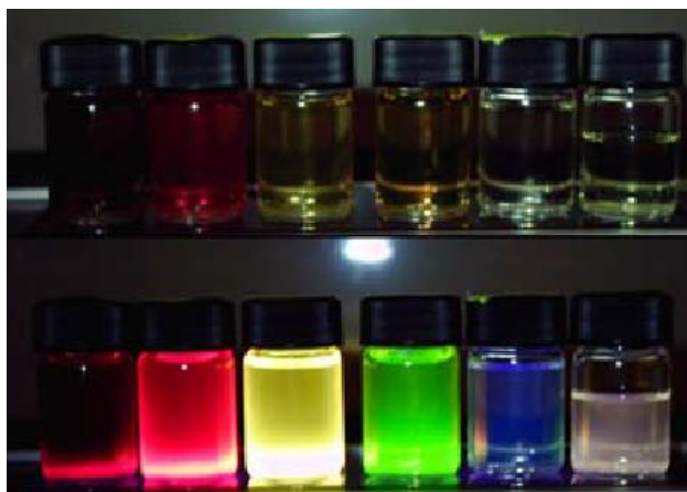
Рис.2. Люминесценция образцов квантовых точек CdS с размером в диапазоне 2.0-5.5 нм, приготовленных в виде зольей. Вверху – без подсветки, внизу – подсветка ультрафиолетовым излучением.
