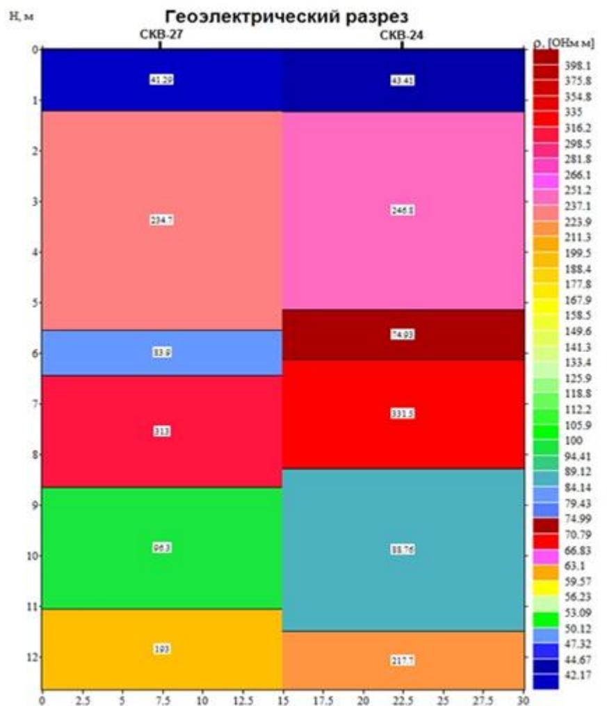
Рисунок 1- Геозлектрический разрез по данным радиолокационного зондирования.
