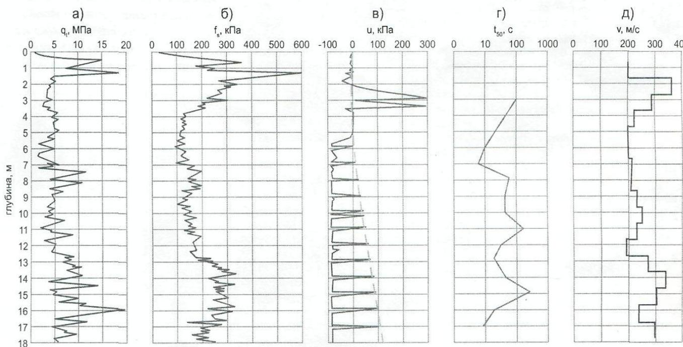
Рисунок 3- Профили, построенные по результатам испытаний с использованием сейсмозонда:
