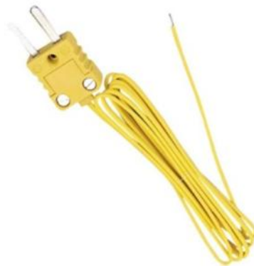
Рис.2 Внешний вид типичной термопары.
