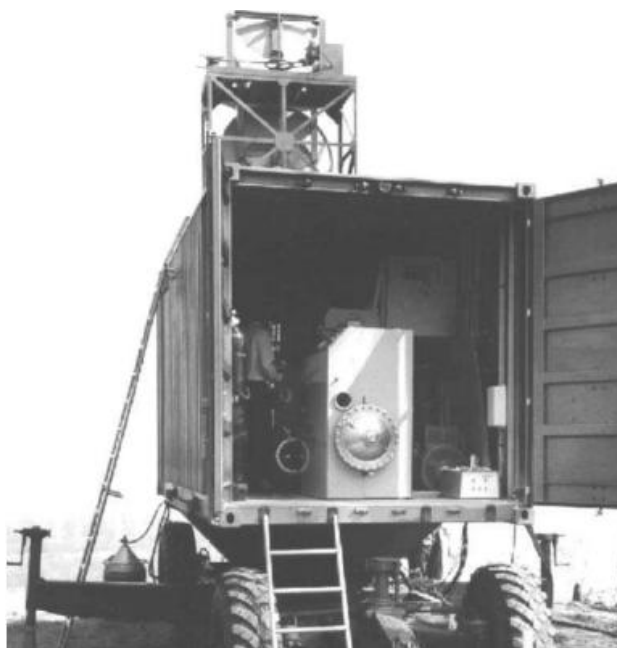
Рис. 1. Кабина передатчика для системы NAGIRA. Задняя часть импульсного силового генератора SINUS. В нижней правой части показан мотор-генератор, питающий основную мощность. Нижняя антенна на крыше - передающая антенна, а верхняя - приемная.
