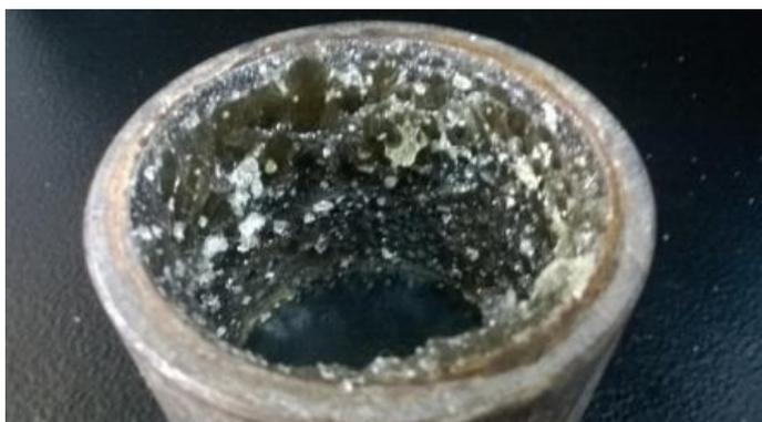
Рисунок 3. Обойма после испытания: на стенках видны остатки тампонажного состава (когезионный характер разрушения).
