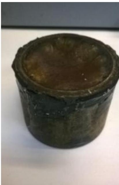
Рисунок 2. Тампонажный состав, отвержденный в металлической обойме
