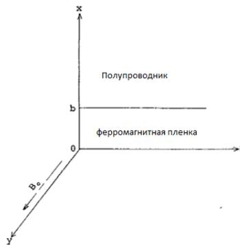
Рис.1 Схема структуры ферромагнитная пленка-полупроводник.
