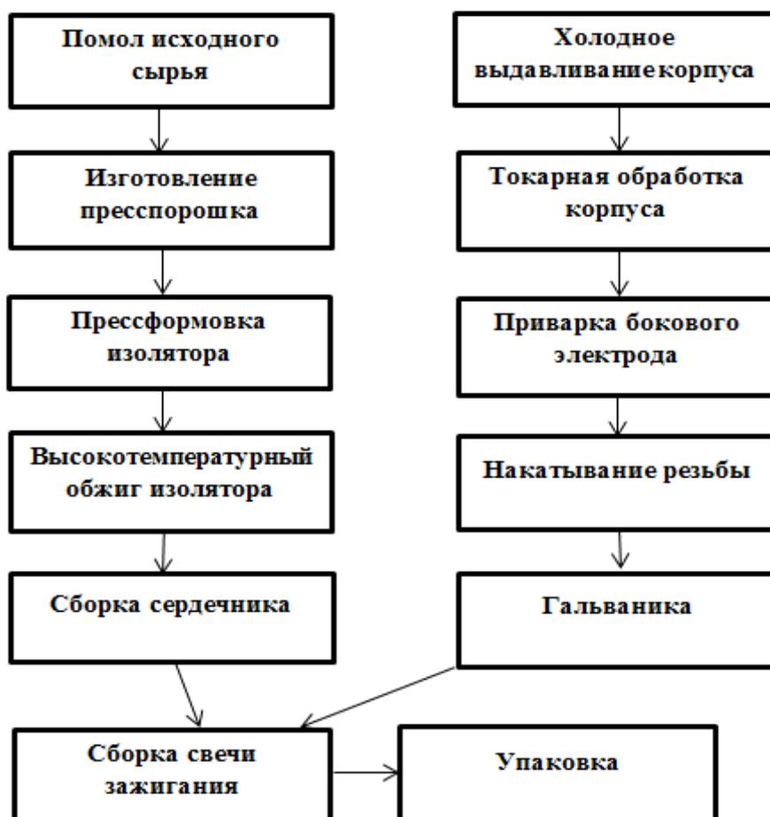
Рисунок 1 – Технология производства автомобильных свечей зажигания
