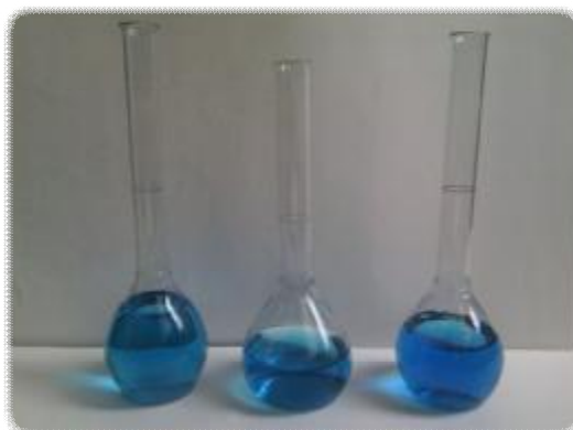
Рисунок 1- Растворы продуктов взаимодействия ионов железа (III) с K_4[Fe(CN)_6] в кислой среде в отсутствие H_2O_2
