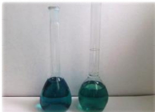
Рисунок 3 – Растворы продуктов взаимодействия Fe(III) с K_4[Fe(CN)_6] в присутствии H_2O_2
