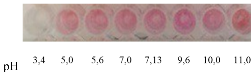
Рисунок 1 – Отклик пленки с ДМГ на ионы Ni(II) при различных значениях рН раствора
