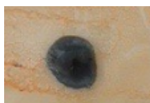
Рисунок 8 – Пленка с РК на часовом стекле с добавкой ионов Ni(II) при оптимальном pH=7.0
