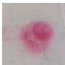
Рисунок 3 – Пленка с ДМГ на часовом стекле с добавкой ионов Ni(II) при оптимальном pH (9,6)
