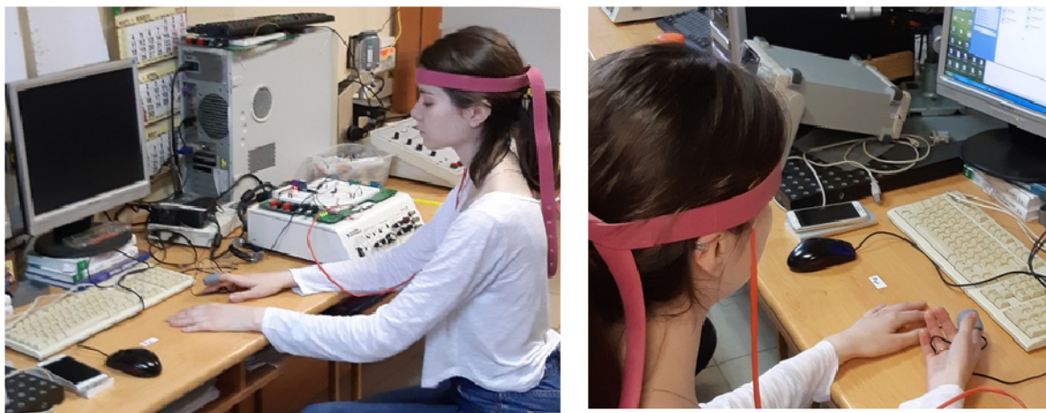
Рис. 5. Фотография одного из испытуемых с закрепленными датчиками во время снятия показателей ФПГ.
