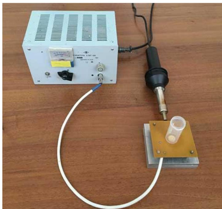
Рис.3. Фотография установки для генерации высокоинтенсивного сфокусированного ультразвукового пучка
