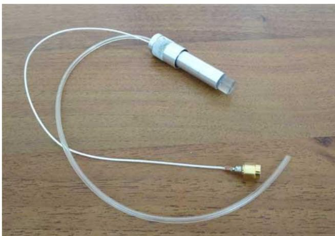
Рис.7. Фотография оптоакустического объектива
