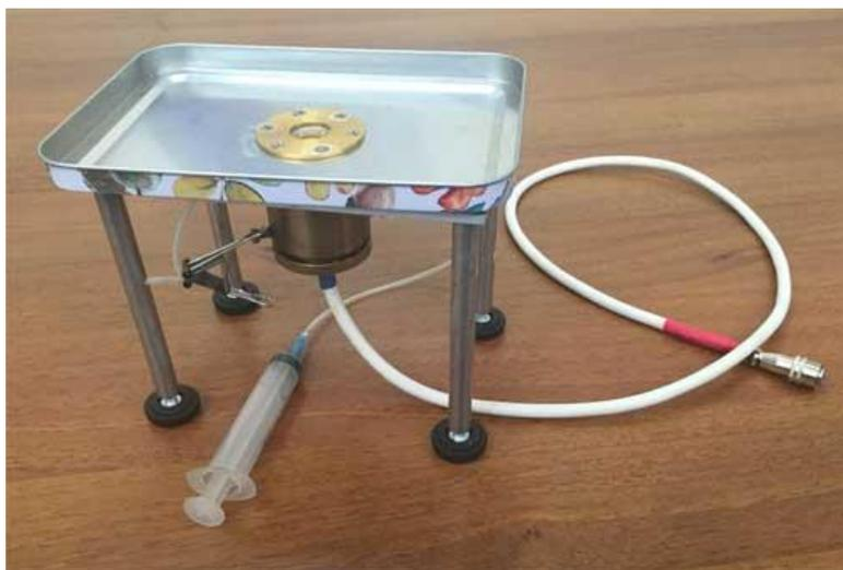
Рис.5. Фотография акустического модуля установки для комплексного опто-акустического исследования и ультразвукового HIFU воздействия на биологические объекты
