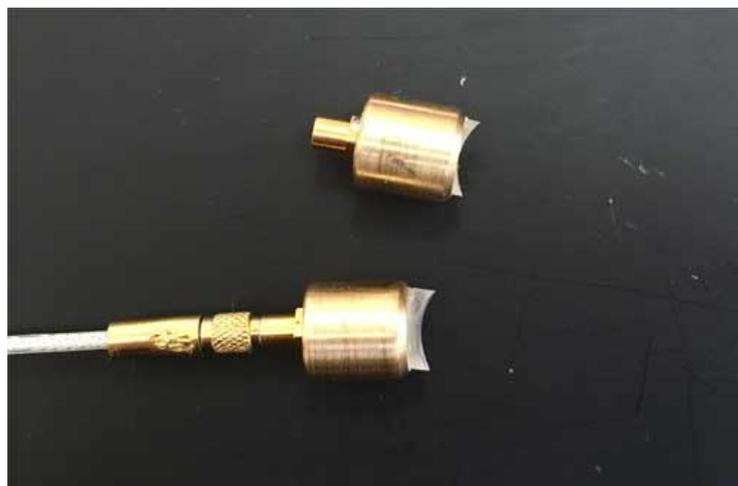
Рис.6. Фотография ультразвуковых датчиков с цилиндрической линзой для опто-акустических исследований
