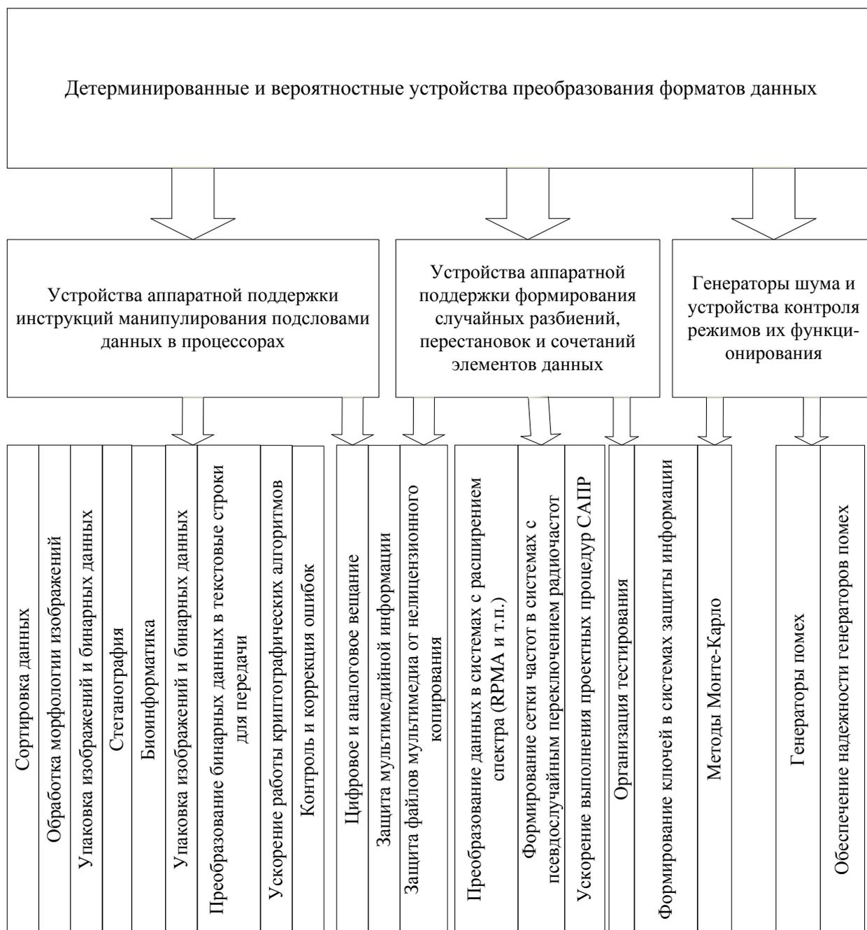
Рис. 1. Структура задач, эффективно решаемых с использованием устройств преобразования форматов данных
