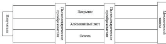
Рисунок 1 – Структурная схема измерения для возбуждения волн.
