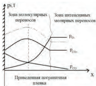
Рис. 1. Зоны молекулярных и молярных переносов у поверхности частицы
