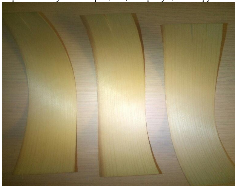
Рис. 2. Листы шпона, полученные вращающимся режущим инструментом
