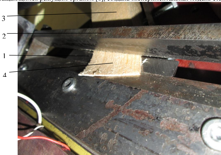
Рис. 1. Режущий блок экспериментальной модели станка: 1 – нож; 2 – прижимная линейка; 3 – заготовка; 4 – лист шпона
