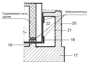
Рис.3. Схема виброизоляции цокольного этажа в основании здания.
