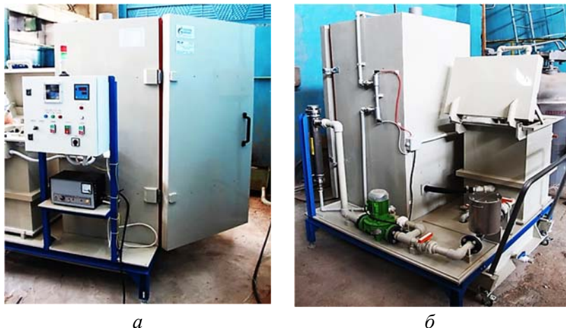
Рис. 4. Опытный образец установки – фронтальный вид со стороны панели управления (а); вид со стороны гидросистемы (б)
