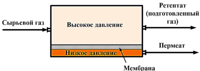
Рис. 1. Принципиальная схема мембранного газоразделения
