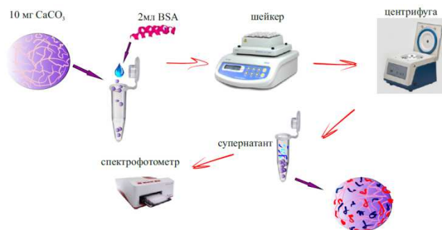
Рис.1. Схема установки для получения частиц и адсорбции белка
