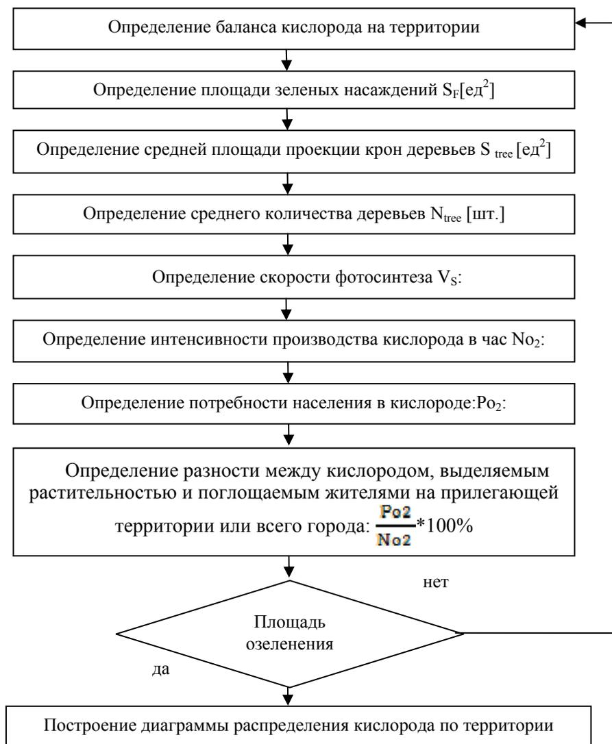
Рисунок 1. Блок - схема алгоритма определения кислородного баланса (Использованы материалы расчета, разработанного д.т.н. Луканиным. В.Н.) [14]
