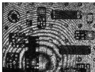
Рис. 3. Голографические интерферограммы тепловых смещений платы при изменении ее температуры на различную величину: а - \Delta T \approx 5^\circ C , б - \Delta T \approx 10^\circ C
