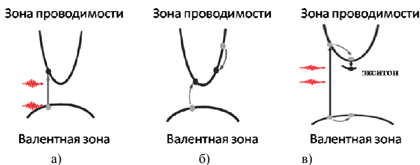
Рис. 4. Переходы свободного электрона при двухфотонном поглощении (а), при лавинной ионизации (б) и переход фотоиндуцированных электронов в связанные состояния (экситоны) в запрещенной зоне (в).
