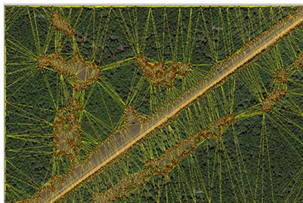
Точки измерения рельефа, триангуляционная сеть
