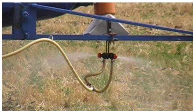
Рисунок 2. Фрагмент рабочего процесса пневмогидравлического устройства нанесения раствора пестицида на растения щелевыми распылителями пневмогидравлического устройства экспериментального образца опрыскивателя при проведении лабораторно – полевых исследований
