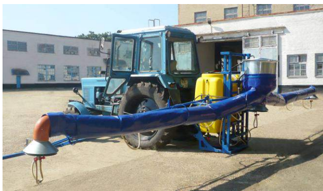
Рисунок 1. Экспериментальный образец штангового опрыскивателя в составе трактора МТЗ 80 при проверке работоспособности воздухо-распределительной системы с пневмогидравлическими устройствами
