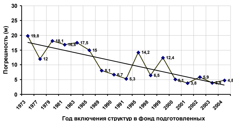
Рисунок 1. Динамика изменения осреднённой по годовому интервалу априорной погрешности структурных построений в Саратовской области
