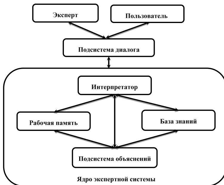
Рис. 2. Структура экспертной системы проектирования строительства подземного строительства.
