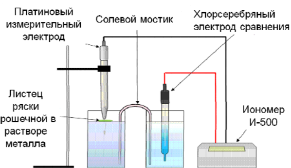
Рис. 1. Схема измерения поверхностного потенциала листочков ряски
