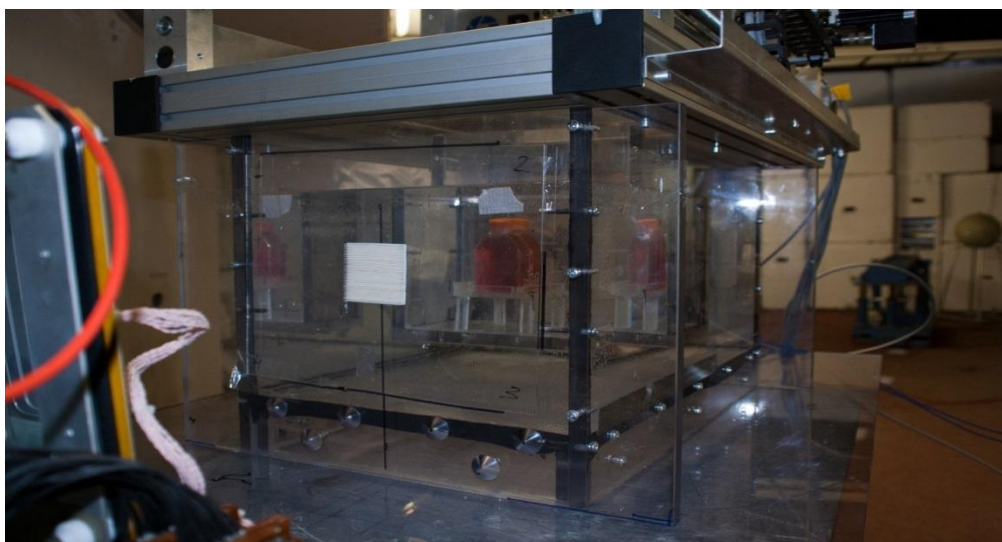
Рис. 1. Общий вид ВРБС при облучении монослоёв клеточных культур. На передней стенке водного фантома - изготовленный фильтр
