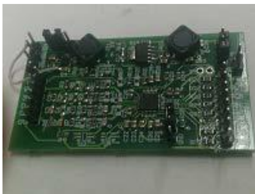
Рис. 1. Отладочная плата на базе AFE ADS1292R
