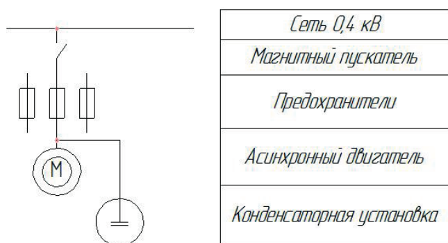
Рис. 1. Схема включения КУ при индивидуальной компенсации
