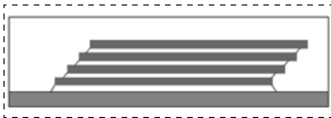
Рис. 1. Схема 3D-ИС, объединяющей в одном корпусе четыре кристалла, расположенных стекком
