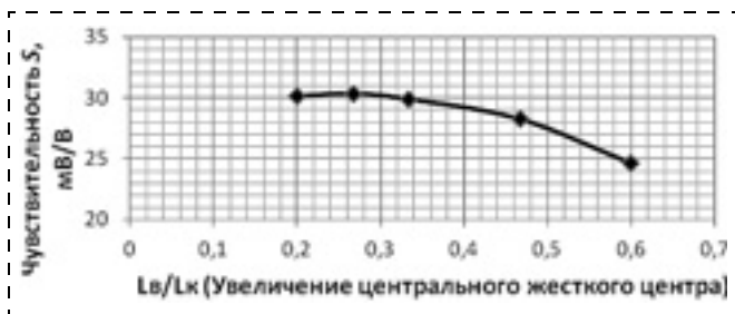
Рис. 6. Зависимость чувствительности конструкции от размеров концентраторов при P_{\text{ном}} = 10 кПа
