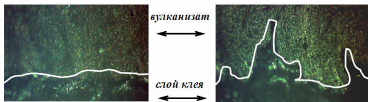
Рисунок 1 — Микрофотографии срезов вулканизатов-СКИ-3 (х 400 кратное увеличение)
