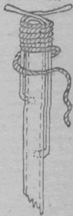
Рис. 9. Прикрепление сачка к палке.
