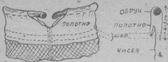
Рис. 8. Прикрепление сетки к обручу.
