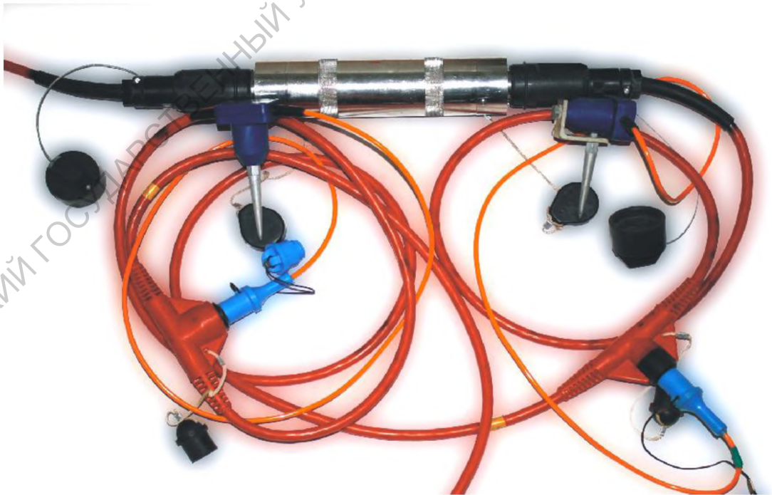
Рис. 3.2. Полевой модуль «ТЭЛЛС-1» с присоединенными сейсмоприемниками
