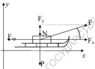
1.8. Нагруженные сани движутся по горизонтальной поверхности у под действием силы  $F$ , приложенной к центру тяжести. Какой угол  $\alpha$  должна составлять линия действия силы  $F$  с горизонтом, чтобы равномерное движение саней происходило под действием наименьшей силы?
