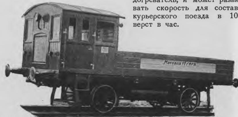
Мотовоз для буксирования вагонов, постр. в 1923 г. (Яросл. авто-ремонтн. завод).
