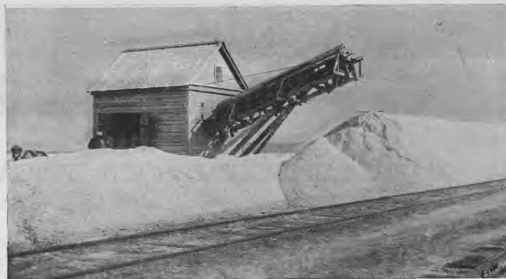
Приспособление для механической разгрузки вагонеток с солью.
