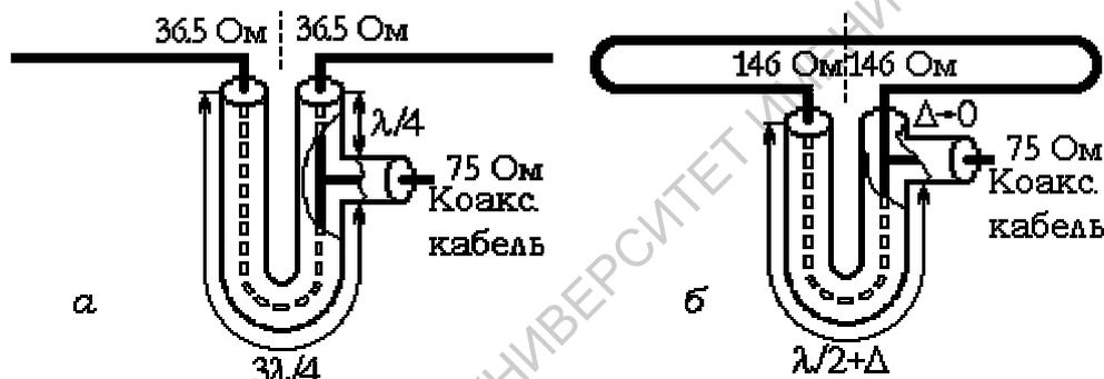
Рис. 13.18. Согласование электрического (а) и магнитного (б) полуволновых вибраторов
